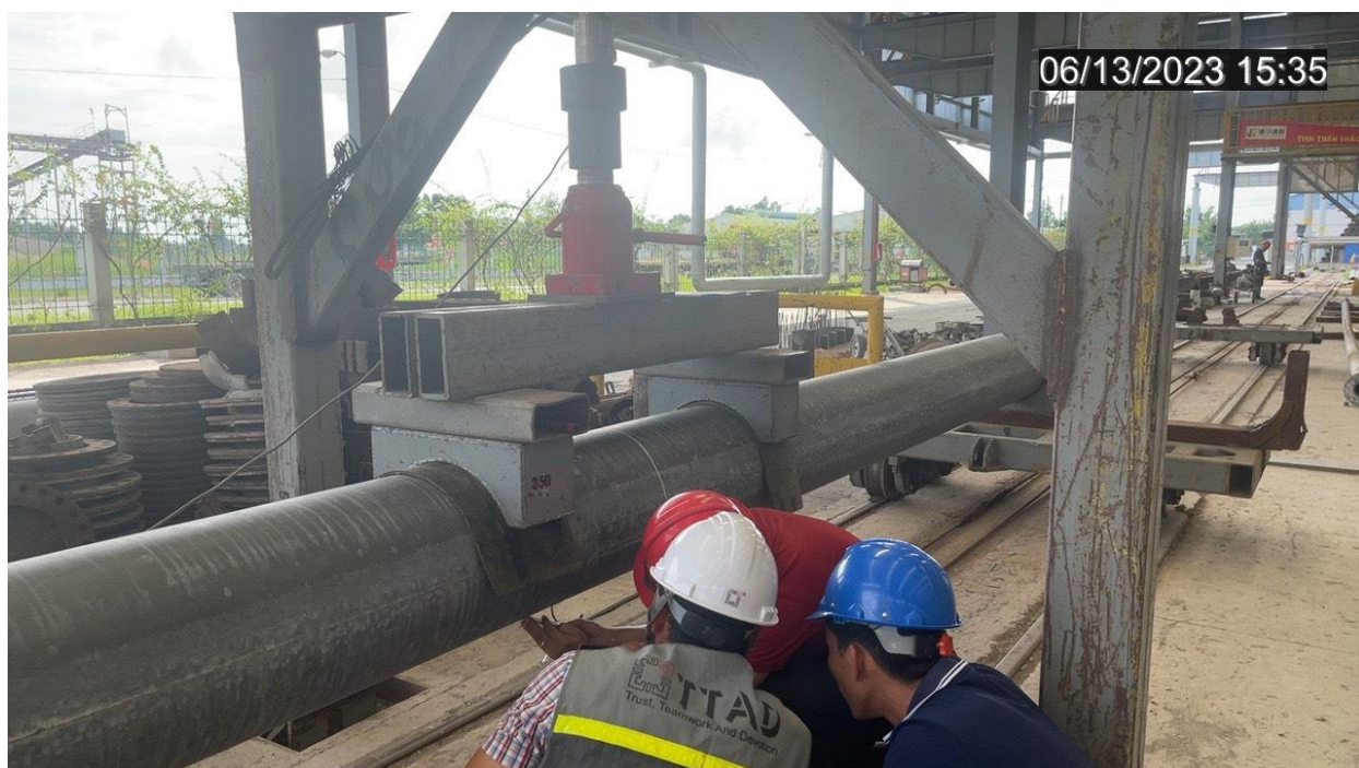
THÍ NGHIỆM MÔ MEN UỐN CỦA CỌC BTCT LY TÂM BENDING MOMENT TEST OF CENTRIFUGAL CONCRETE PILE
